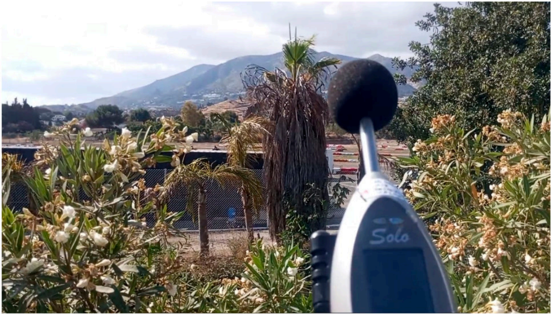
Fotografía de ensayo acústico Lkeq,T
